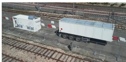
Fig.: Hidrogenadora portable (sector ferroviario). Proyecto FCH2Rail
